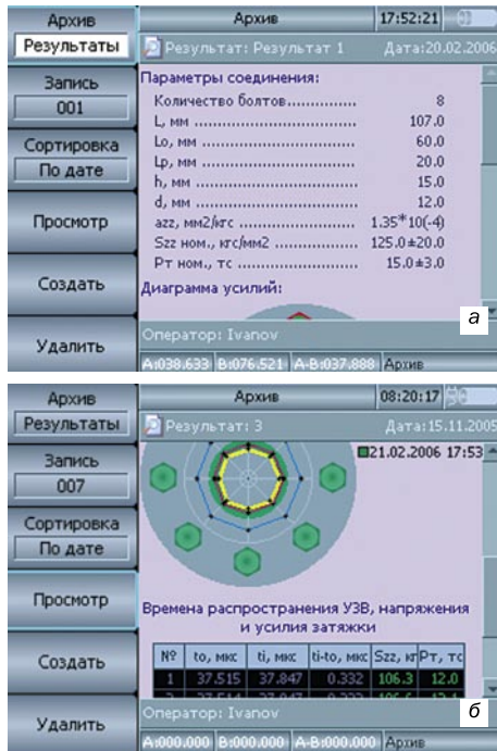
Рис. 5. Просмотр результатов контроля: а – параметры соединения; б – диаграмма усилий
